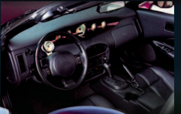
Uniek ontworpen dashboard met ovaal instrumentenpaneel, meters met witte achtergrond en toerenteller op de stuurkolom.
