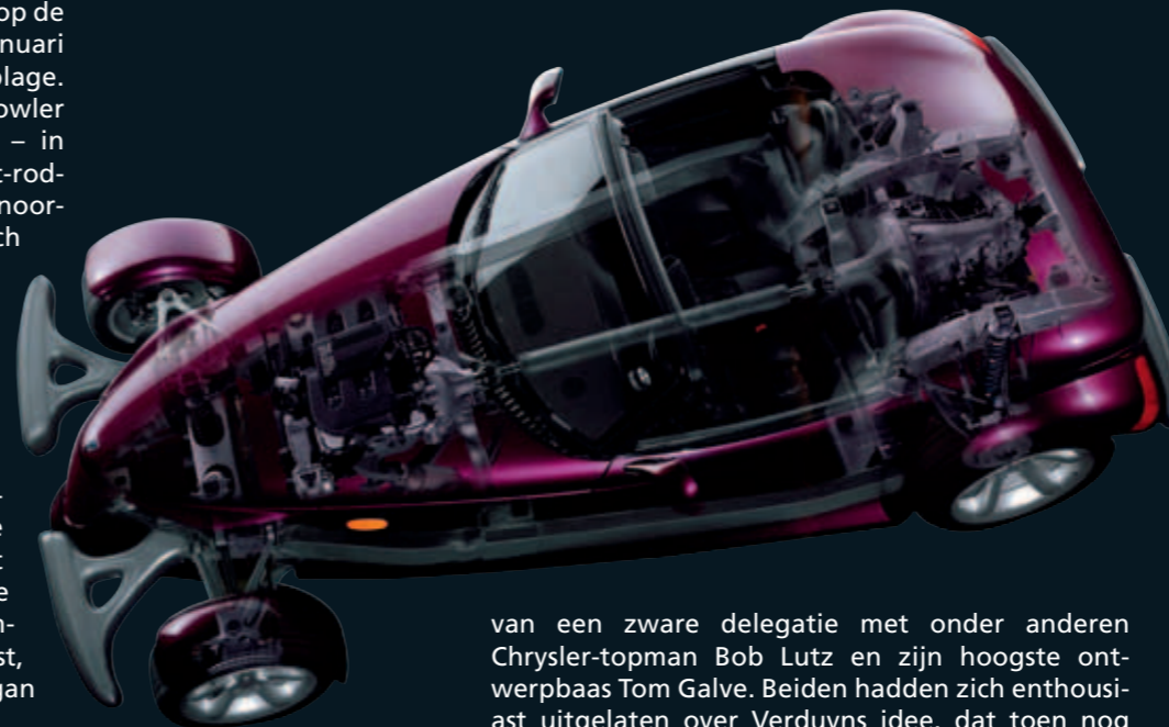
Deze tekening toont de midden/voor liggende motor en de versnellingsbak bij de achteras.
